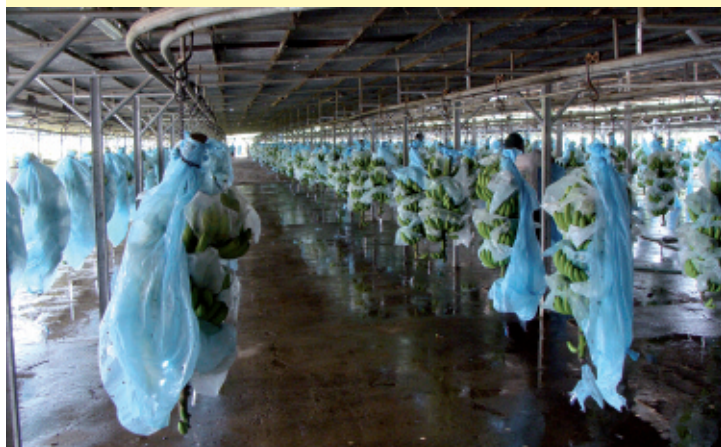
Figuur 11. Een kabelbaan transporteert bananen naar het inpakstation. (Bron: WUR)
